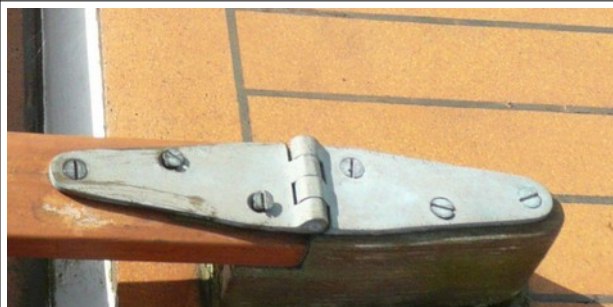
Uitstekende schroeven van het scharnier van het voorluik.
